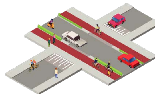
Figuur 21: inritconstructie aan viertaks kruispunt
