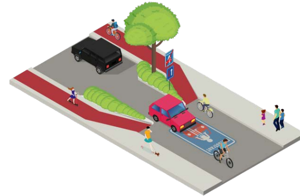
Figuur 4: rugdekking voor fietsers bij overgang naar gemengd verkeer
