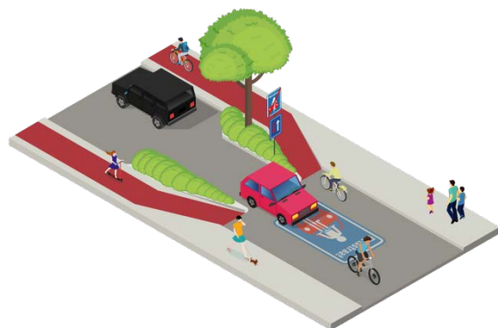
Figuur 11: overgang fietspaden naar gemengd verkeer
