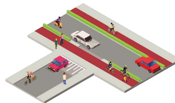
Figuur 20: inritconstructie aan drietaks kruispunt
